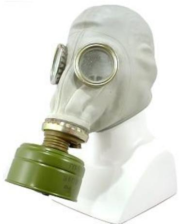
Шлем – маска противогаза изготавливается пяти ростов (0;1;2;3;4). Определение требуемого роста лицевой части осуществляется по результатам замера сантиметровой лентой вертикального обхвата головы, который определяется путем измерения головы по замкнутой линии, проходящей через макушку, щеки и подбородок. Полученный результат округляют до 0,5 см.
